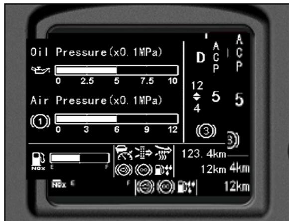
Antes de solta o travão de mão e inicie o veículo, você deve agurar até que a pressão do sistema chegasse 0.55MPa (5.5bar), as luzes de aviso se apagassem e o alarme sonoro parasse de sair som. Só que a pressão no barômetro tivesse atingido 0.7MPa (7bar), o sistema de freio funcionará e pronto para iniciar o veículo.
