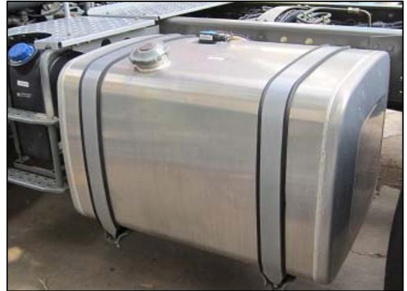
Solte a rolha de parafuso de porta de drenagem no fundo do tanque②, e pode emitir completamente o óleo diesel no tanque.
