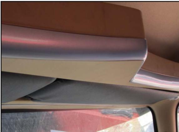
O estado de colapso de placa dianteira de proteção solar
