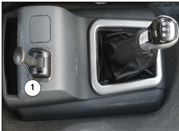
usa a câmara de ar de freio de reserva de mola em inverno--o levantamento de freio de estacionamento
