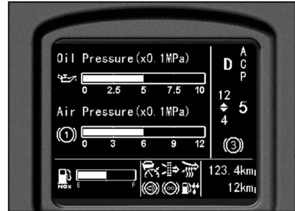
No visor do motorista aparece não deve aparece qualquer aviso tais como STOP, Alarme de Pressão de Óleo quando o motor está ligado
